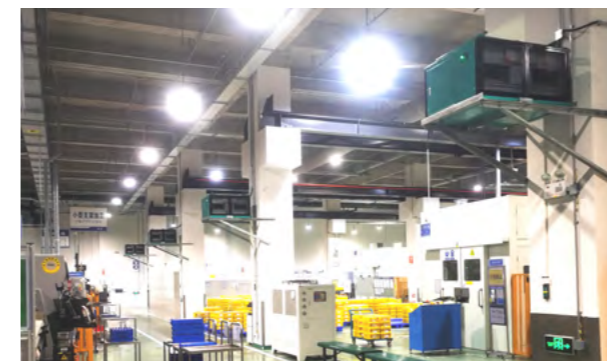
珠海松下马达有限公司通过导入油雾净化器, 改善切削时产生油雾的问题, 避免安全事故发生
